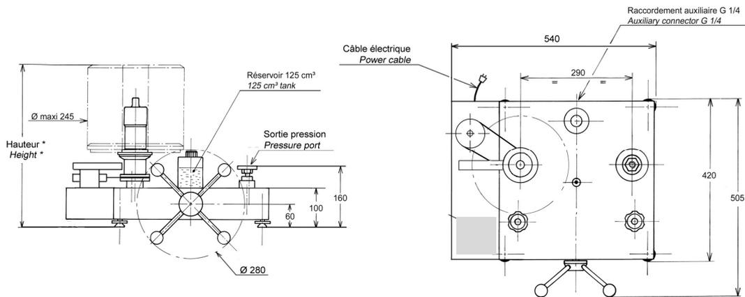
Hauteur avec jeu de poids standard : (bar, kPa) : 450 mm (PSI) : 465 mm
