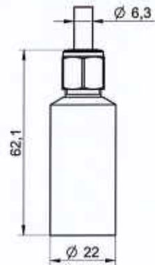
Boîtier avec sortie de câble, 3 conducteurs, 1,5 m longueur
