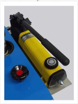
Pompe de gavage
