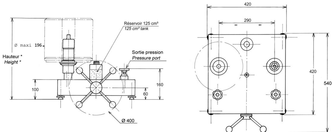
Hauteur avec jeu de poids standard : (bar, kPa) : 450 mm
