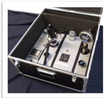
Mallette pour aménagement de poste et transport (OPxxxx) grande : 355 x 505 x 310 mm - poids à vide : 13 kg + (OPxxxx) petite : 290 x 250 x 310 mm - poids à vide : 5 kg
