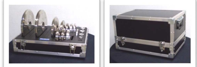
Mallette pour aménagement de poste et transport (OPxxxx) petite : 290 x 250 x 310 mm - poids à vide : 5 kg (OPxxxx) grande : 355 x 505 x 310 mm - poids à vide : 13 kg
