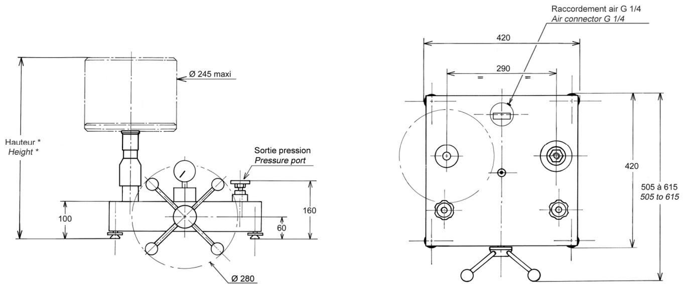
Hauteur avec jeu de poids standard : (bar, kPa) : 480 mm (PSI) : 455 mm
